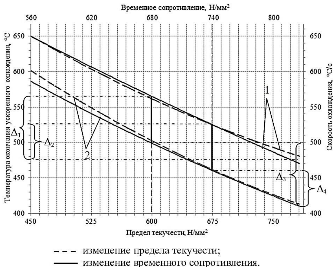
Рис. 3. Влияние температурно-временных параметров охлаждения на механические характеристики термически упрочненного проката Ø 16 мм из стали марки СтЗсп:
